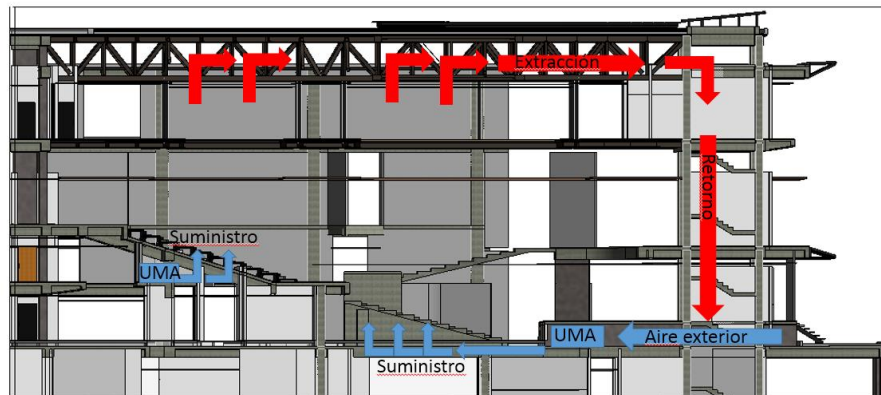
Esquema 1. Sistema de ventilación por desplazamiento
